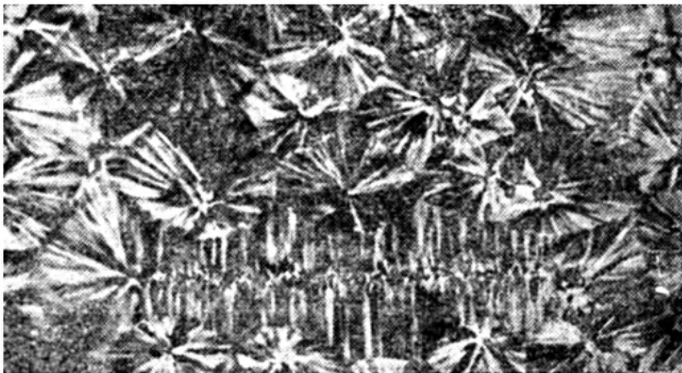
Рис. 9.4. Пачки молекул полипропилена.
