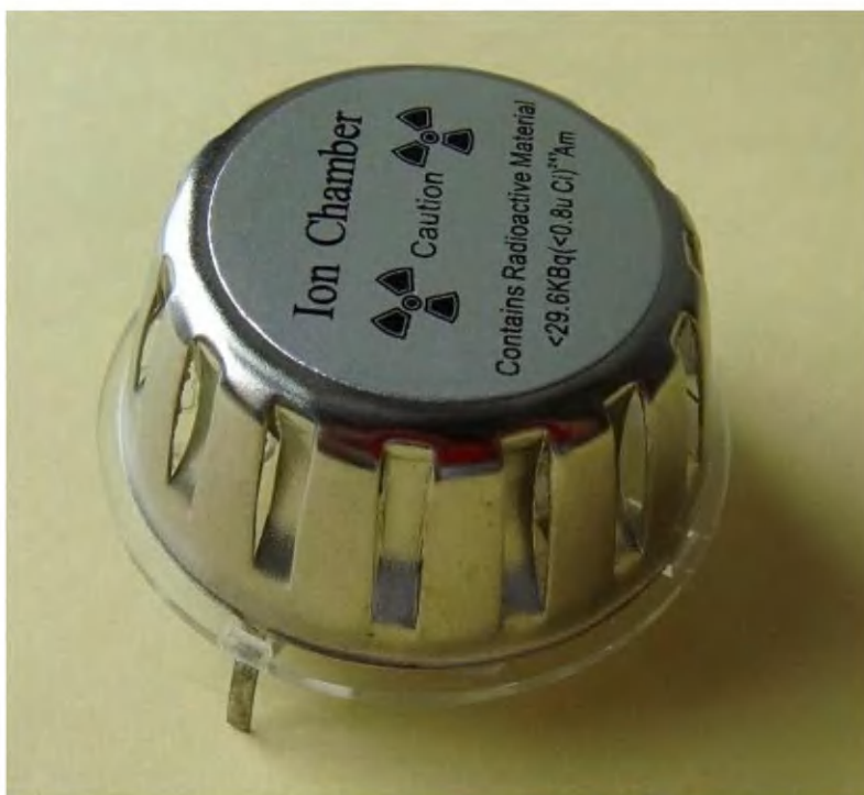
Ионизационная камера HIS-07 (NAP-07) для детектора дыма.
